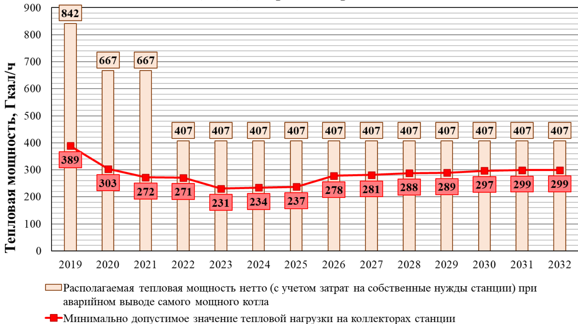
Рисунок 6.6 – Баланс тепловой мощности и подключенной нагрузки Центральной ТЭЦ в аварийном режиме
